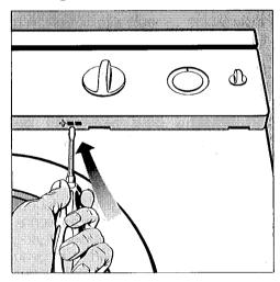
auf der + Seite durch leichten Druck, z.B. mit einem Schraubendreher mit schmaler Klinge, betätigen.
