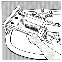
Ziehen Sie den Saugheber aus der Kammer \\*/ heraus und reinigen Sie ihn ebenfalls mit warmem Wasser.
