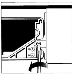
Waschmittelschubkasten wieder einsetzen, Entriegelungsknopf drücken und gleichzeitig den Schubkasten einschieben.
