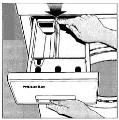
Reinigen Sie die Einspülkammern und den Weichspülkanal von der Rückseite am besten mit warmem Wasser und einer Flaschenbürste.
