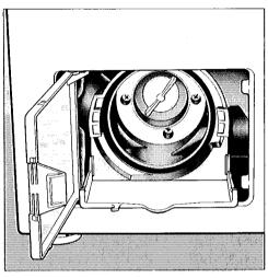
Setzen Sie den Laugenfilter ein und verriegeln den Verschlußdeckel durch Drehen nach rechts. Der Verschlußknebel muß waagerecht stehen
