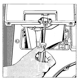
Die Kindersicherung rastet ein, wenn der Schubkasten geschlossen wird.
