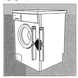
Wird der Automat zwischen Möbel gestellt, so richten Sie die hinteren Füße mit einem Maßband oder Zollstock vor dem Einschieben aus.
