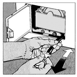
Läuft kein Wasser mehr aus, verschließen Sie den Schlauch wieder.
