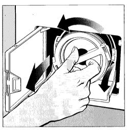
Drehen Sie den Verschlußdeckel nach links und ziehen Sie ihn langsam heraus. Vorsicht: Bei verstopftem Entleerungsschlauch kann eine größere Menge Wasser austreten. Reinigen Sie den Laugenfilter und das Gehäuse-Innere bis zum Laugenpumpenflügel (auf Fremdkörper achten). Drehen Sie den Laugenpumpenflügel mit dem Finger. Läßt er sich nicht leicht drehen, können Gegenstände eingeklemmt sein, die entfernt werden müssen.
