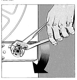
Beide Stangen mit dem Stützblech herausziehen.
