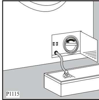
4. Wenn das Wasser vollständig abgelaufen ist, den Deckel der Grobkörperfalle entgegen dem Uhrzeigersinn abschrauben und herausziehen.
