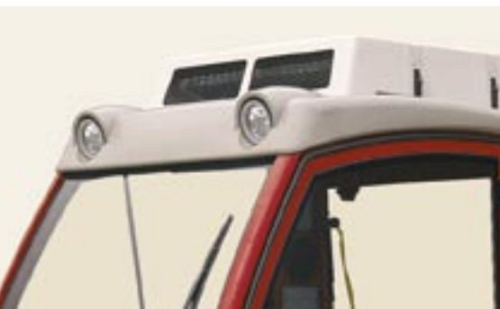
Phares de travail intégrés dans le toit en matière synthétique.
