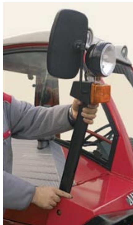
Les phares sont réglables en hauteur et peuvent être démontés si nécessaire.
