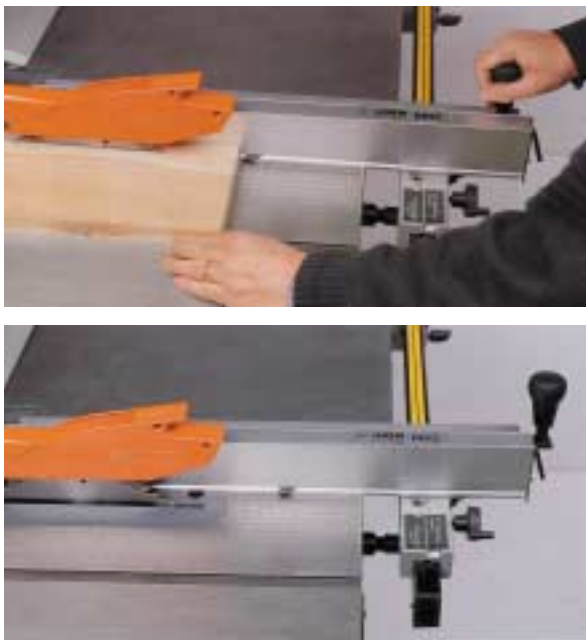
Fig. 22. : Vues du poussoir intégré de marque Lurem - Views of the integrated push stick of the company Lurem
