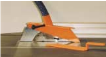
Fig. 16 a Protecteur articulé sur couteau diviseur Marque MORI type Normandie (photo INRS)
