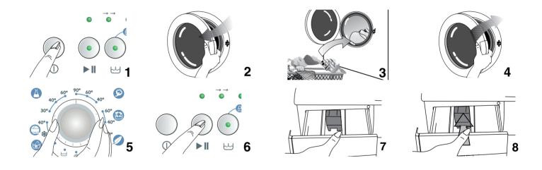
Danach füllen Sie für Ihre Maschine geeignete Waschmittel und Weichspüler in das Gerät ein und schließen den Waschmittelbehälter. Starten Sie die Maschine mit der Start/Pause/Abbrechen-Taste. Die Start/Pause/Abbrechen-Taste leuchtet auf. Während Ihre Maschine arbeitet, können Sie an der Programmanzeige ablesen, was das Gerät gerade tut.
