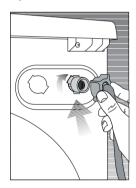
Die mit der Maschine gelieferten Spezialschläuche werden mit den Wasserzulaufventilen der Maschine verbunden. Über den roten oder rot gekennzeichneten Schlauch wird heißes Wasser in die Maschine geleitet, der blaue oder blau gekennzeichnete Schlauch versordt die Maschine mit kaltem Wasser.
