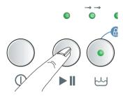
Zum Abbrechen eines Programms halten Sie die Start/Pause/Abbrechen-Taste 3 Sekunden lang gedrückt. Danach beginnt die Maschine mit dem Abpumpen. In der Zwischenzeit leuchten die "Waschen"- und "Programm abgeschlossen"-Leuchten auf. Die "Start/Pause/Abbrechen"- und die "Waschen"-Leuchte erlöschen nach dem Abpumpen. Die "Tür"-Leuchte beginnt zu blinken. Sobald die "Tür"-Leuchte kontinuierlich leuchtet, können Sie die Tür öffnen, ein neues Programm auswählen und starten.
