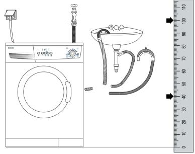
Das Ende des Wasserablaufschlauches kann direkt an den Abfluss oder an einen speziellen Anschluss am Rohrbogen des Waschbeckens angeschlossen werden. Der Schlauch sollte in einer Höhe von mindestens 40 und maximal 100 cm angeschlossen werden
