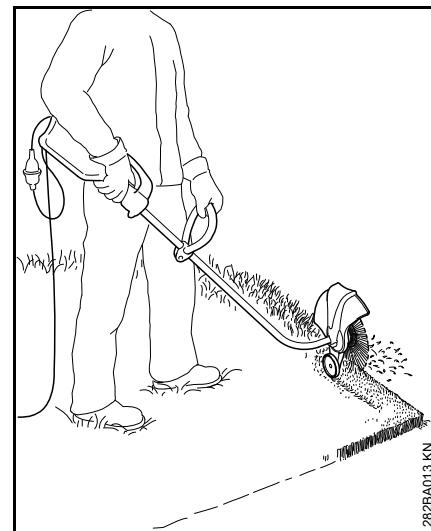
Maskinen förvandlas enkelt till en kantklippare (se "Ombyggnad av maskinen till kantklippare").
