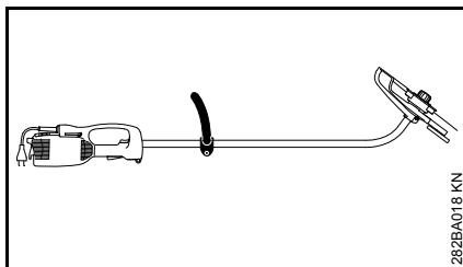
A gép 180°-os elforgatásával a gép szegélyvágóként alkalmazható (lásd "Alkalmazás").
