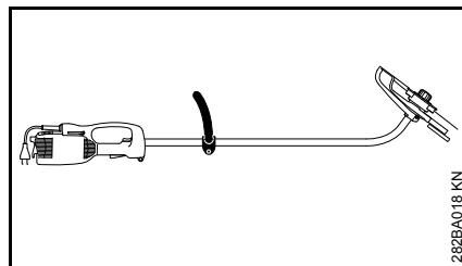
Genom att vrida maskinen 180° är den klar att använda som kantskärare (se "Användning").
