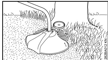
Une roulette peut être facilement installée sur le dispositif (voir « Montage de la roulette »).
