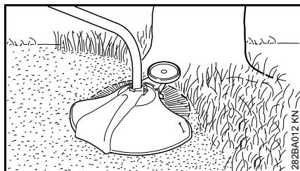
No aparelho pode ser aplicada facilmente uma roda de apoio (vide o capítulo "Aplicar a roda de apoio").
