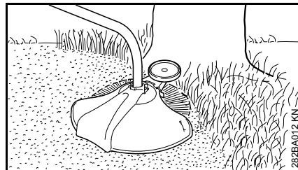
Et støttehjul man monteres på maskinen med få håndgrep (se „Montere støttehjul“).
