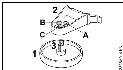
Koło dystansowe (1) można zaryglować na mocowaniu (2) trzech różnych pozycjach (A, B lub C). W ten sposób można zmieniać odstęp sznura tnącego w stosunku do obrabianej krawędzi.
