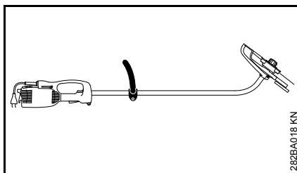
Durch Drehen des Gerätes um 180° ist das Gerät als Kantenschneider einsatzbereit (siehe "Anwendung").
