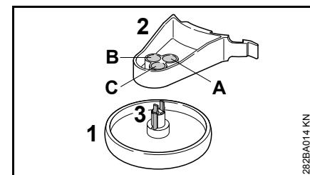
Het steunwiel (1) kan in drie verschillende standen (A, B of C) op houder (2) worden vergrendeld. Hierdoor kan de afstand van de maaidraad ten opzichte van de te bewerken rand variëren.
