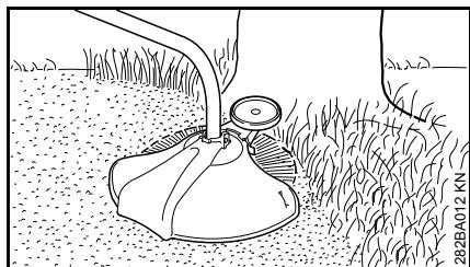
A támaszkerék néhány egyszerű művelettel felfszerelhető a gépre (lásd "A támaszkerék felszerelése").
