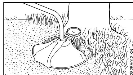
Con poche manovre è possibile montare sull'apparecchiatura una rotella di sostegno (ved. "Montaggio della rotella di sostegno").
