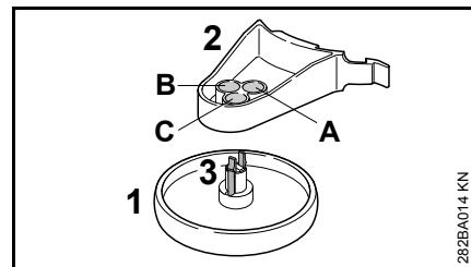
La rueda de apoyo (1) se puede fijar en tres posiciones diferentes (A, B o C) en el soporte (2). De esta manera, se modifica la distancia del hilo de corte respecto del borde objeto del trabajo.
