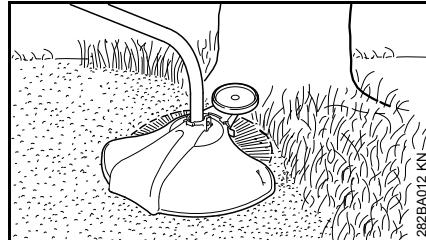
Με λίγες κινήσεις, μπορείτε εφοδιάστε το μηχάνημά σας με έναν τροχό στήριξης (βλέπε "Τοποθέτηση τροχού στήριξης").
