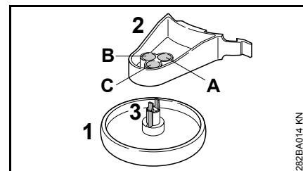
Das Stützrad (1) kann in drei verschiedenen Positionen (A, B oder C) am Halter (2) arretiert werden. Dadurch wird der Abstand des Mähfadens zur bearbeitenden Kante variiert.
