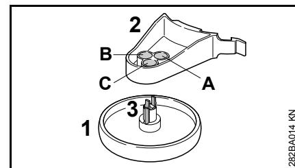
A roda de apoio (1) pode ser retida em três posições diferentes (A, B ou C) no suporte (2). Assim varia a distância do fio de corte ao bordo a trabalhar.
