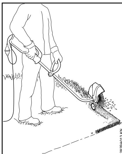
Het apparaat kan in een handomdraai worden omgebouwd tot kantensnijder (zie "Apparaat tot kantensnijder ombouwen").
