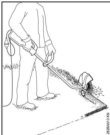
Das Gerät lässt sich mit wenigen Handgriffen zum Kantenschneider umbauen (siehe "Gerät zum Kantenschneider umbauen").
