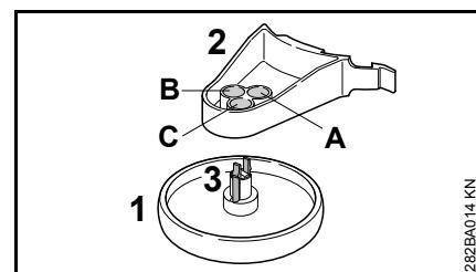
A támaszkerék (1) három különböző beállítási helyzetbe (A, B vagy C) rögzíthető a tartónál (2). Ezáltal a vágózsínór és a levágandó szél közti távolság megváltoztatható.
