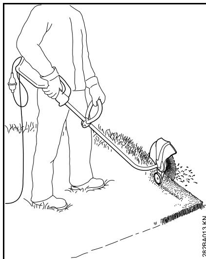
La máquina se puede transformar en un cortabordes con pocas manipulaciones (véase "Transformar la máquina en un cortabordes").
