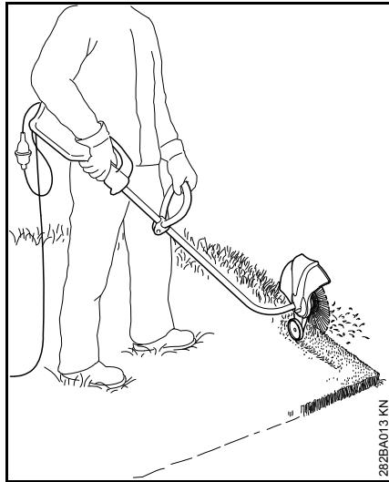
Det er ganske enkelt at ombygge maskinen til kantskærer (se "Ombygning af maskinen til kantskærer").
