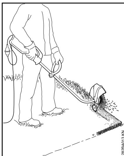
A gép néhány egyszerű művelettel szegélyvágóra átalakítható (lásd "A gép átalakítása szegélyvágóra").
