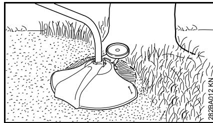
På maskinen kan man med några enkla handgrepp montera ett stödhjul (se "Montering av stödhjul").
