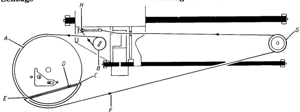
Das Schnurrad A wird gegen die Uhr bis zum Anschlag gedreht, und der Schlitten wird gegen die Mitte bis zum Anschlag verschoben.
