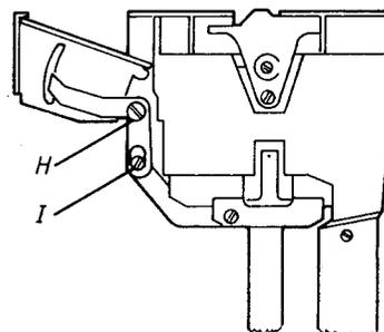
Die Einstellung der Blende erfolgt mit Hilfe der Testschallplatte 3621001 im Testabschnitt 5.
