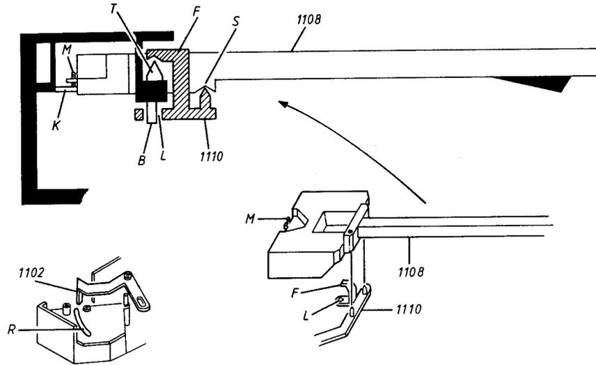
Der Halter, Pos. Nr. 1110, wird angehoben und mit einem Finger im vertikalen Lager S gehalten.
