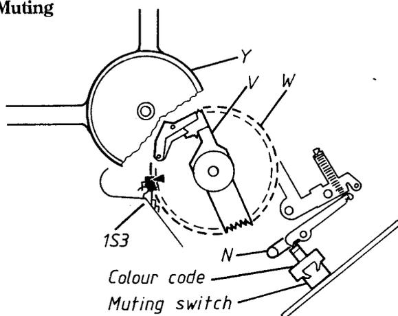
Ohm meter tilsluttes muting switchen som vist, eller ben 2 og 3 på DIN kablet.
