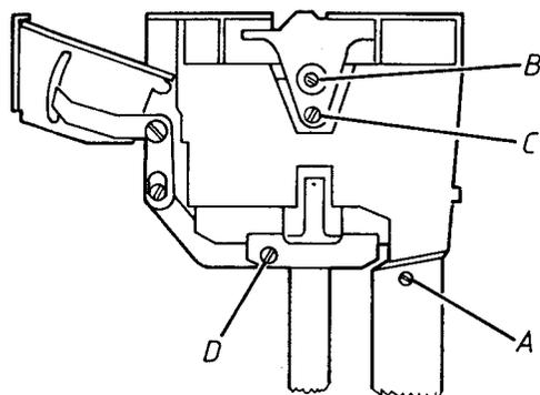
Es wird mit der Schraube A eingestellt, bis der Abstand von der Oberseite des Detektorarms (Spitze des Arms) zum Plattentellerchassis 53 mm beträgt.
