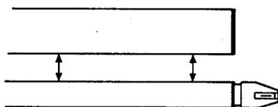
Ajuster à l'aide de la vis C jusqu'à ce que le bras de lecture se trouve en position parallèle avec le bras d'indicateur.
