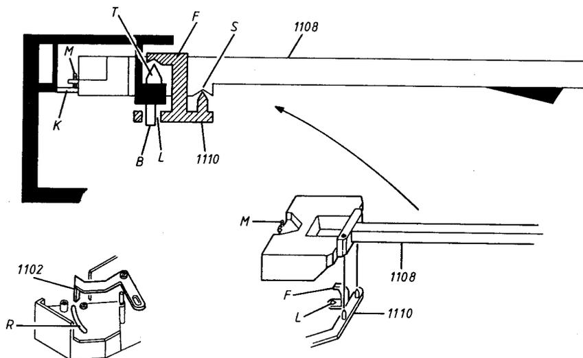
Holderen, pos. 1110, løftes op og holdes med en finger oppe i det vertikale lejes.
