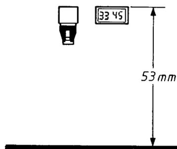
Ajuster à l'aide de la vis A jusqu'à obtenir une distance de 53 mm entre le dessus du bras d'indicateur (au bout du bras) et le châssis.
