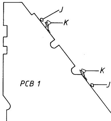
Die Printplatte wird gegen die Zapfen J geschoben.
