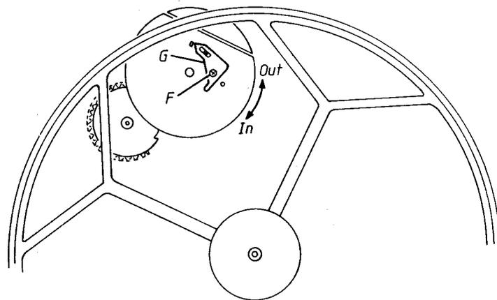
Die Einstellung des 30-cm-Absetzpunktes erfolgt durch Lösen der Schraube F, Drehen des Winkels G und anschließendes Festziehen der Schraube F.
