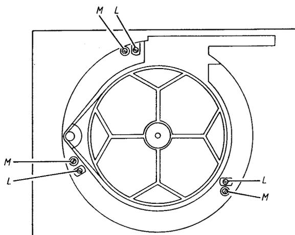
Es wird mit den Schrauben L eingestellt, bis der Abstand von der Abdeckplatte zur Oberseite des Plattentellers 2,5 - 3 mm beträgt, wobei der Schlitten bei dieser Messung gegen die Mitte verschoben sein muß.
