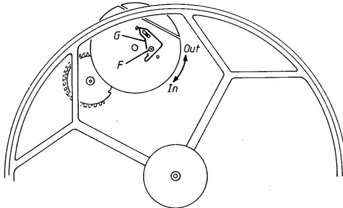
Justering af 30 cm nedslag foretages ved at løsne skruen F, dreje vinklen G og derefter spænde skruen F.
