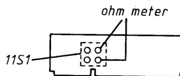
Ein Ohmmeter wird wie gezeigt an den Muting-Schalter oder an Anschluß 2 und 3 des DIN-Kabels angeschlossen.
