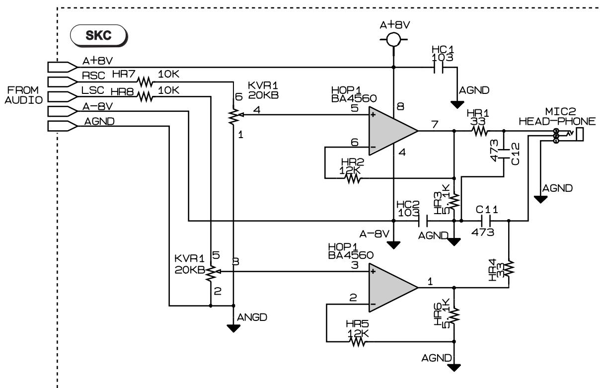
AUDIO 5.1 CHANNEL SCHEMATIC DIAGRAM - SCHEMA DES CIRCUITS AUDIO 5.1 - SCHALTBILD 5.1 MULTIKANAL AUDIO - SCHEMA DEI CIRCUITI AUDIO 5.1 -
