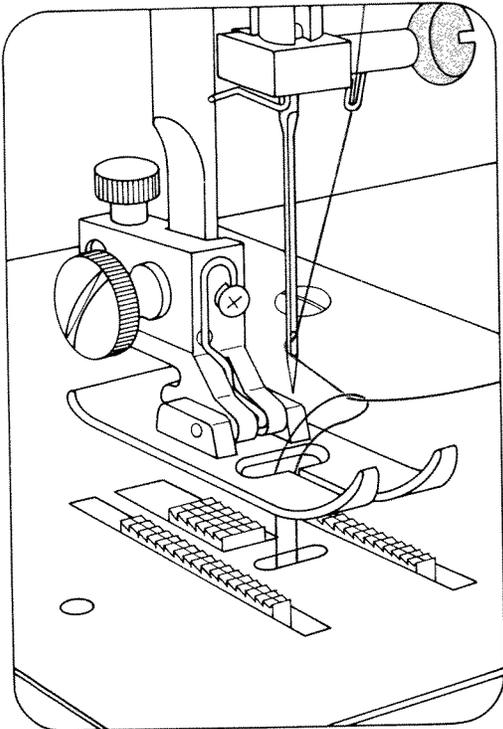
Oberfaden festhalten. Handrad nach vorn drehen und einen Stich nähen. Nadel und Fadenhebel müssen oben stehen. Mit dem Oberfaden den Unterfaden nach oben ziehen.
