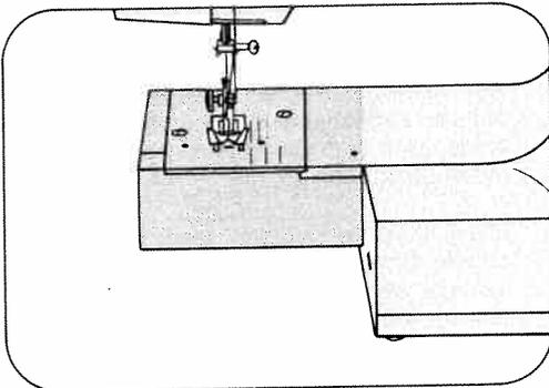
Die Maschinen haben einen Freiarm für röhrenförmiges Nähgut.
