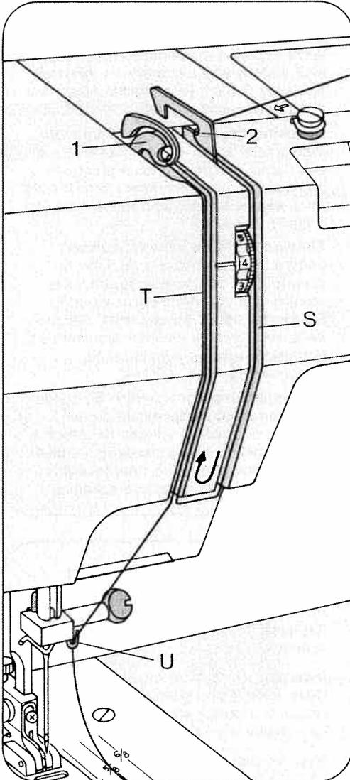
**Oberfaden einlegen:** Nadel und Fadenhebel müssen oben stehen. Nähfuß anheben. Den Faden in die Führung 2, den Schlitz S, nach oben in den Schlitz T, in den Fadenhebel 1, zurück durch den Schlitz T und in die rechte Führung U am Nadelhalter ziehen.
