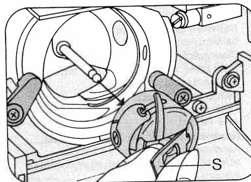
Klappe S anheben und die Spulenkapsel herausziehen.
