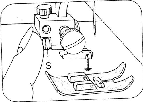
**Nähfuß auswechseln:** Netzstecker ziehen. Roten Knopf S drücken. Der Fuß rastet aus.
