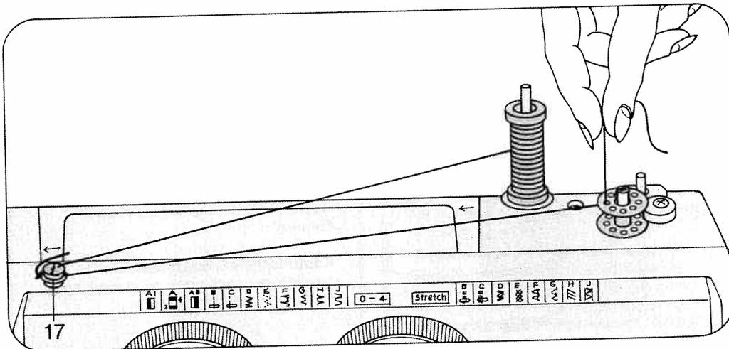
**Spulen:** Den Faden von der Garnrolle in die Spulervorspannung 17 ziehen, zur Spule führen, durch ein Loch der Spule fädeln und festhalten. Den Fußanlasser betätigen und aufspulen. Dabei den Faden nach einigen Umdrehungen loslassen. Die volle Spule nach links drücken, abnehmen und den Faden abschneiden.
