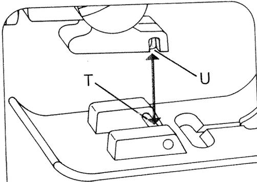
**Nähfuß anbringen:** Stoffdrückerhebel senken und den Fuß dabei so schieben, daß der Steg T in die Nuten U einrastet.
