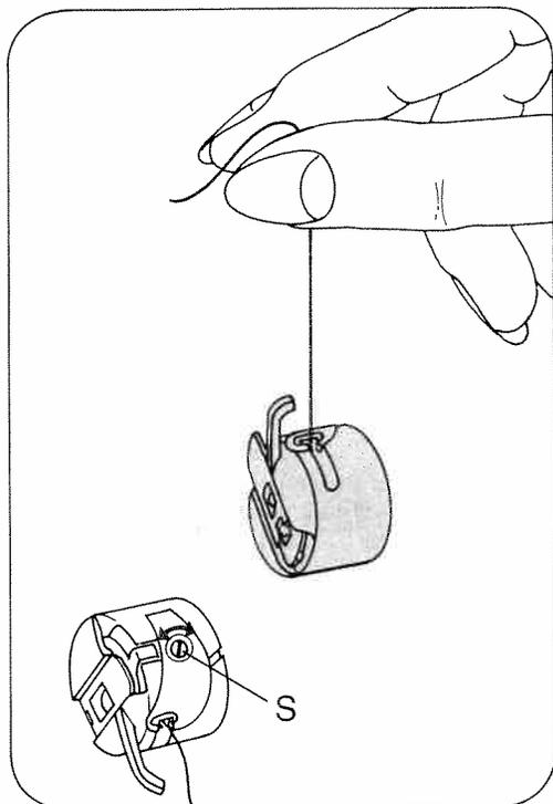
**Unterfadenspannung prüfen:** Kapsel leicht ruckartig aufwärtsbewegen. Sie muß stufenweise niedersinken. (Einstellschraube S nach links drehen = schwächer, nach rechts drehen = fester).
