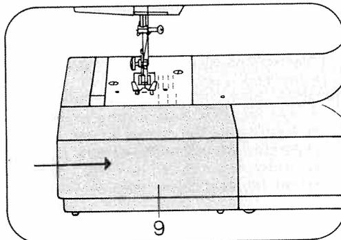
Nähfläche 9 an die Maschine schieben (Führungsstifte in die Bohrungen).
