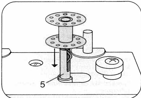
Spule auf die Spulerspindel 5 stecken.
