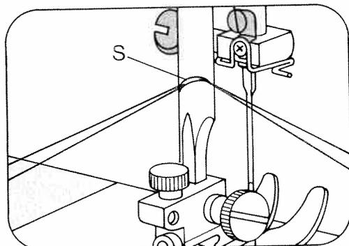
**Fadenabschneider S.** Fäden einlegen und nach unten ziehen.
