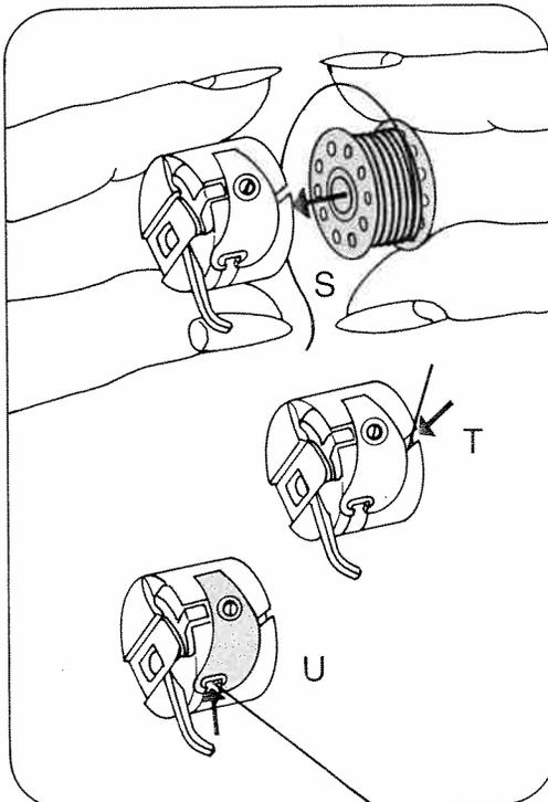
**Spule einlegen S** (Faden nach hinten). Den Faden in den Schlitz T und unter der Feder hindurch in die Öffnung U ziehen.
