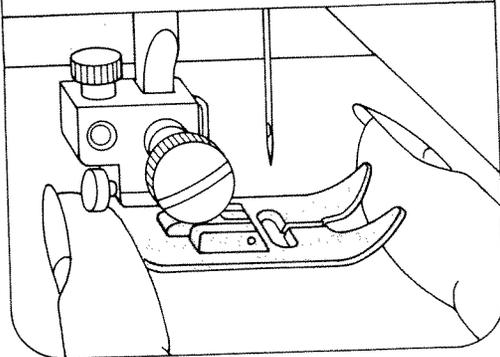
V und W sind zum **Befestigen des Lineals**. X ist die Nähfußhalterschraube.
