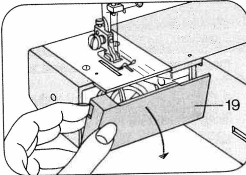
Verschlussklappe 19 nach unten öffnen.
