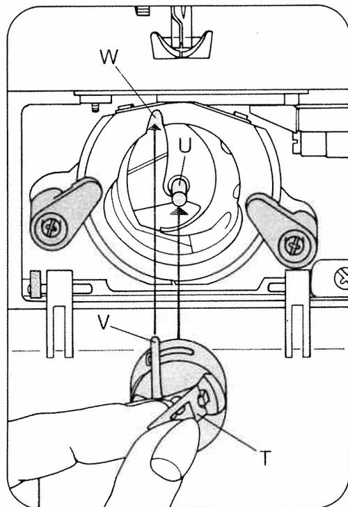
**Spulenkapsel einsetzen:** Klappe T anheben und die Kapsel bis zum Anschlag auf Stift U schieben. Der Kapselfinger V muß dabei in den Ausschnitt W eingreifen.
