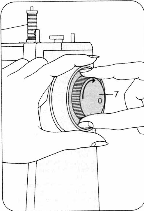
**Nähwerk einschalten:** Das Handrad festhalten und die Scheibe 7 nach hinten drehen.
