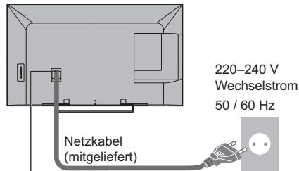
**Schieben Sie den Netzstecker bis zum Anschlag ein.**
