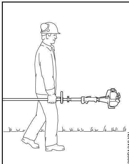
Puede acarrearse solamente en posición horizontal. Agarre el eje de una manera que mantenga la máquina equilibrada horizontalmente. Mantenga el silenciador caliente lejos de su cuerpo y el accesorio de corte detrás de usted.
