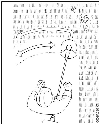
Todos los tipos de pasto y malezas se pueden cortar fácilmente con la cuchilla de cortar pasto. Para ello, la herramienta motorizada se mueve en forma de arco, como si fuera una guadaña.
