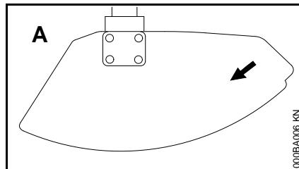
Las flechas en el deflector (A) (vista de abajo) muestran el sentido correcto de rotación del accesorio de corte. Sin embargo, al verlo de arriba, el accesorio de corte gira en sentido contrahorario.
