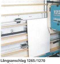
zusätzlicher Maßanschlag im unteren Bereich des Gestells, damit längere und schwere Streifen auch auf den Schichtholzauflagen geschnitten werden können.
