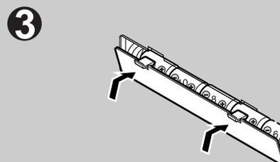
**Zum Entfernen der Batterien nehmen Sie zuerst Batterie Nr. „10“ heraus.**
