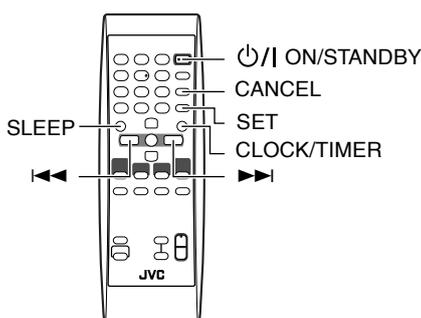
Les minuteries permettent de programmer automatiquement les fonctions d'écoute et d'enregistrement.
