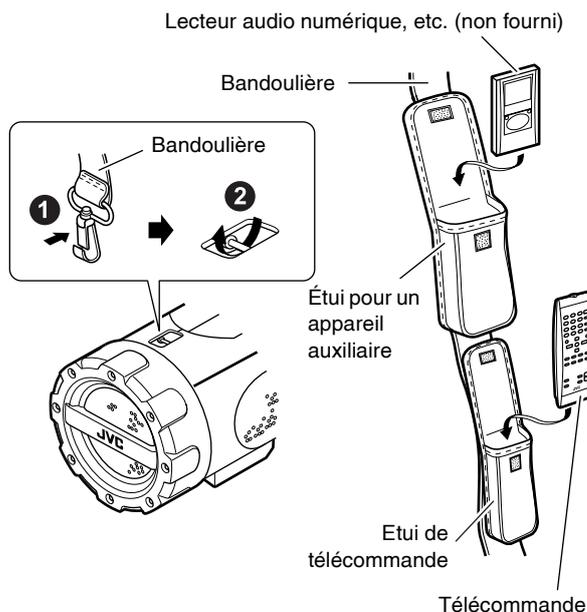
Pour détacher la bandoulière, appuyez sur le crochet et détachez-le de l'axe.
