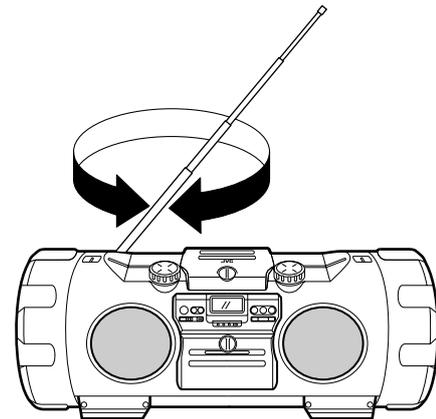
**Bei MW/LW:** Richten Sie das Gerät so aus, dass bester Empfang erzielt wird.
