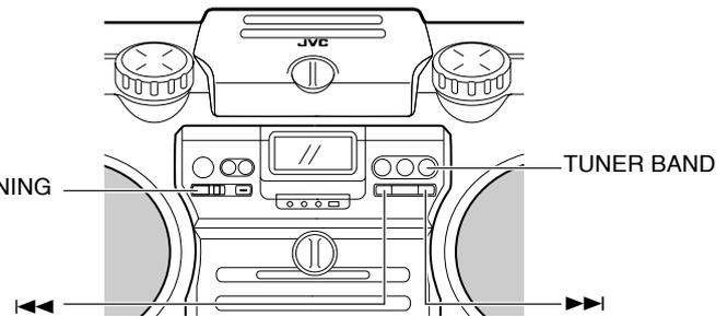
Sie können UKW- und MW/LW-Sender hören. Sender können von Hand eingestellt, automatisch gesucht oder aus dem Senderspeicher gewählt werden.
